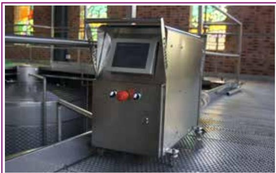
La macchina è portatile e leggera per utilizzarla in tutti i serbatoi della cantina. Non ha bisogno di installazione né modificazione dal serbatoio.
